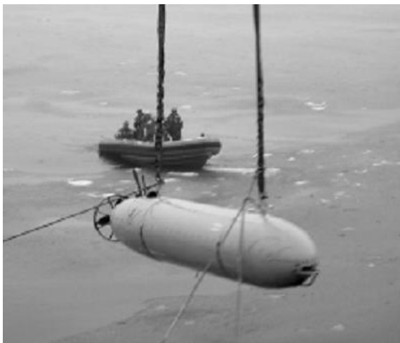
c) Robot Mbari's Altex Auv hoạt động dưới đáy biển sâu ở Bắc Cực
